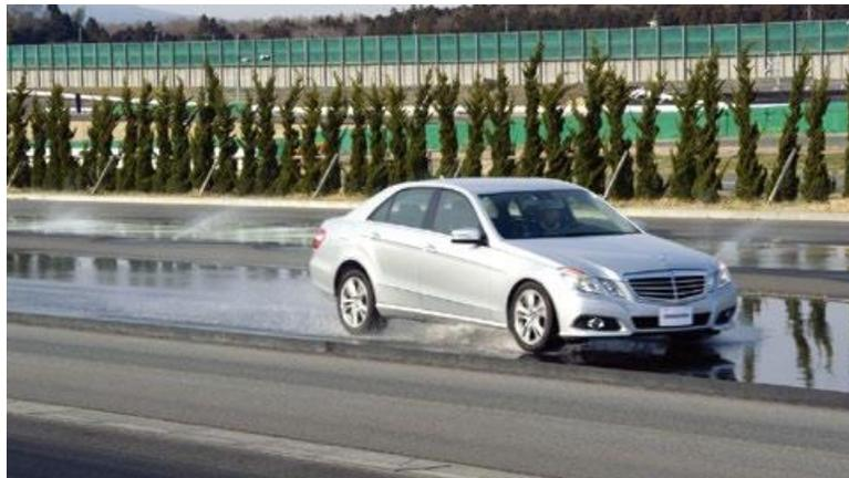
Photo 5 : ウエット路面上での制動性能試験
