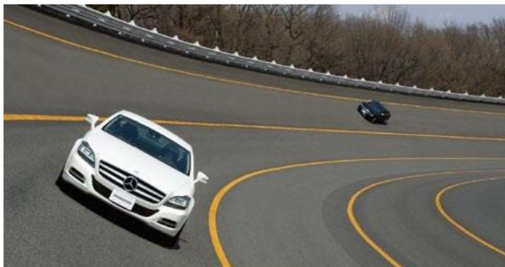
Photo 7 : 傾斜 38 度の道路での走行安定性評価
