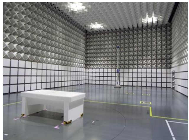
Photo 2：10m 法電波暗室（X線遮蔽機能付）
