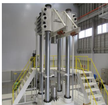
写真4 大型疲労試験機
