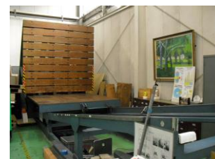
坂から斜めに落下する時の衝撃試験
